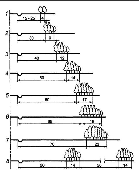
Объемы снегоприноса: 1 - 25 м3/м; 2 - 50 м3/м; 3 - 75 м3/м; 4 - 100 m3/m; 5 - 125 m3/m; 6 - 150 m3/m; 7 - 200 m3/m; 8 - 250 m3/m
